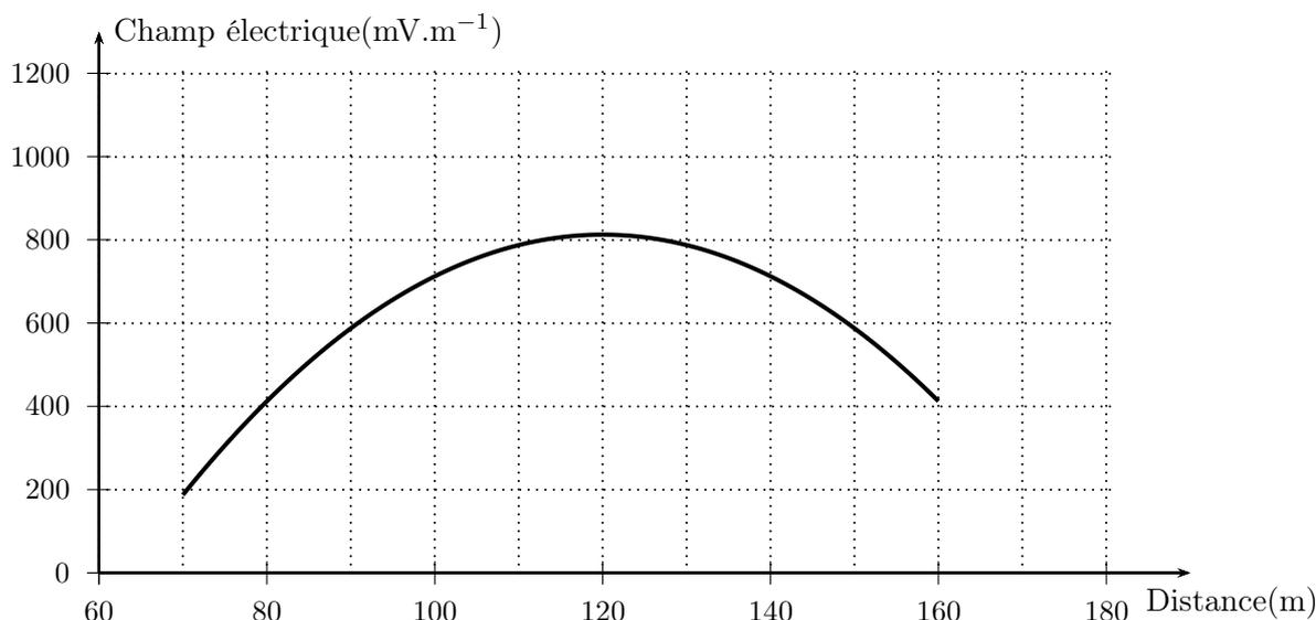
Le champ électromagnétique est inférieur à  $600 \text{ mV}\cdot\text{m}^{-1}$  pour  $x \in [70; 90] \cup [150; 160]$ , c'est à dire pour des habitations situées à une distance entre 70 et 90 m de l'antenne relais, ou entre 150 et 160 m de l'antenne relais.
